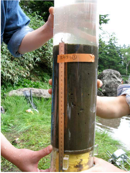
八幡平蓬莱沼の湖底から採集し、解析に用いた柱状堆積物
